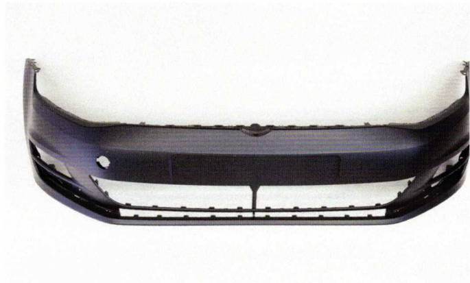
Listwa zderzaka IAM od producenta I.S.A.M. S.p.A. bez podkładu.
