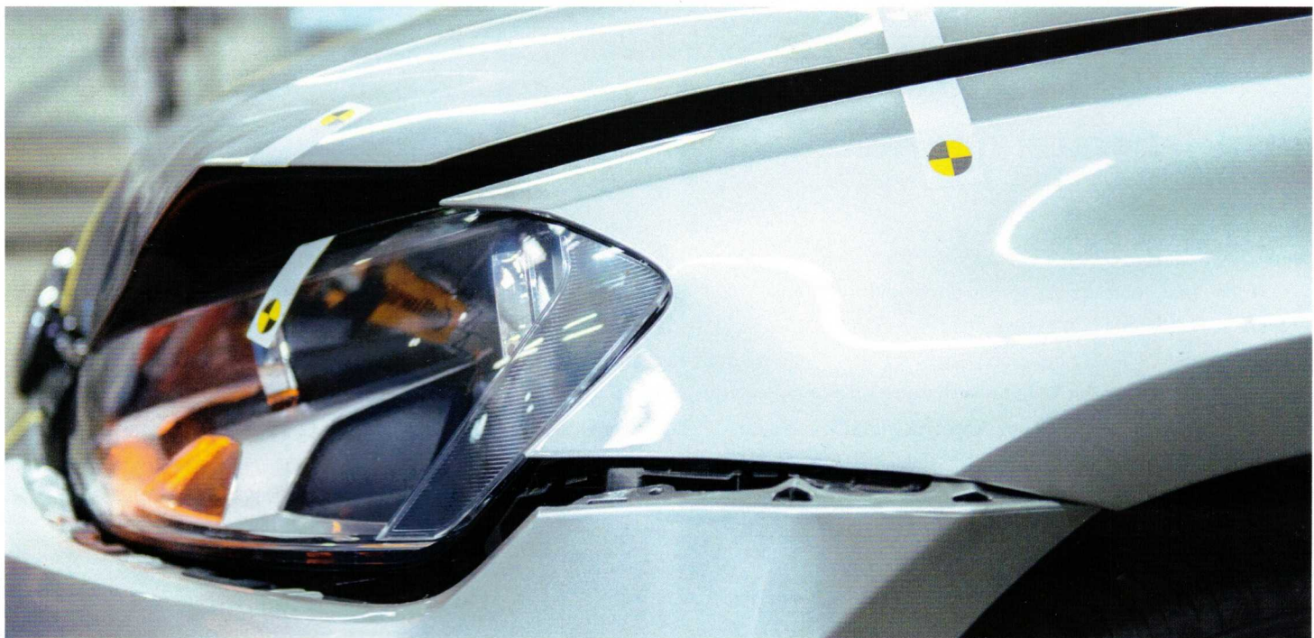
Golf VII z częściami IAM. Odkształcenia po zderzeniu.
