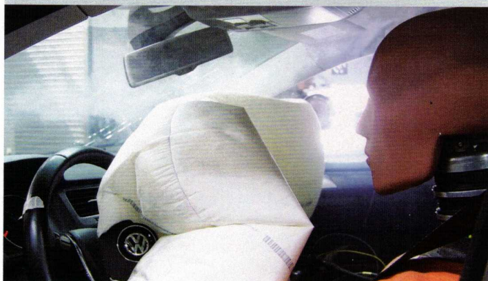
Uruchomione poduszki bezpieczeństwa. Wnętrze Golfa VII z częściami IAM po zderzeniu.
