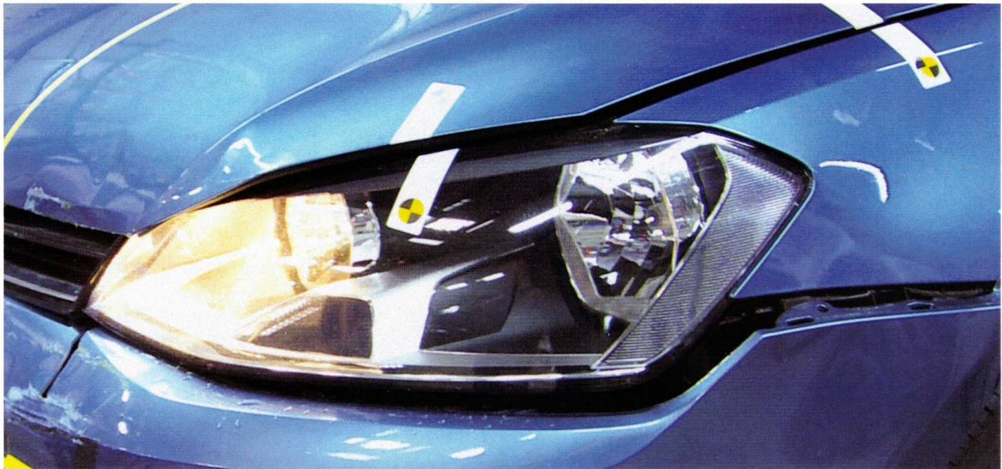
Golf VII z częściami Genuine Parts. Odkształcenia po zderzeniu.
