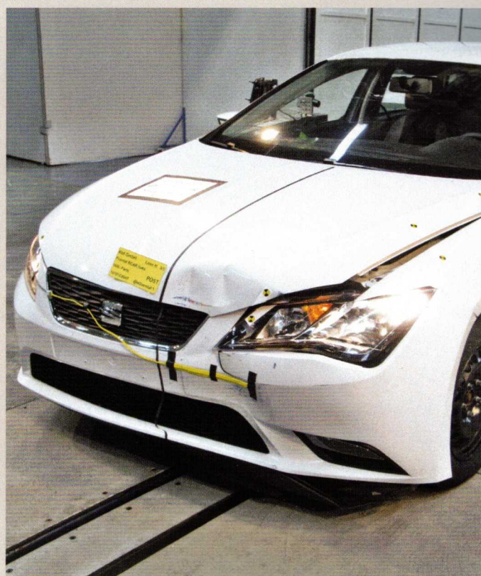
SEAT Leon III, wyposażony w komponenty IAM, po teście zderzeniowym.
