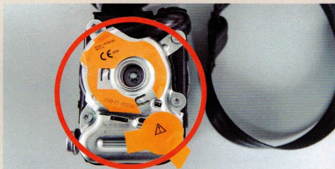
SEAT Leon III z elementami IAM. Uszkodzona uszczelka napinacza paska.
